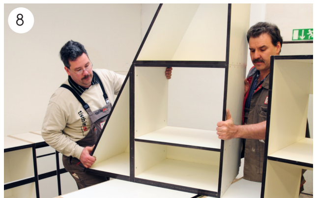
8 In der Tischlerei wird die Küche zur Kontrolle vormontiert, bevor sie beim Kunden eingebaut wird.
