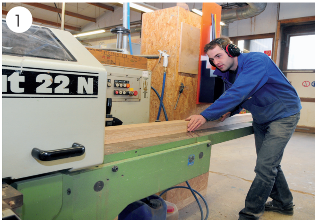
1 Mit dem Vierkanthobel werden die Profile aus Holz auf das richtige Format gebracht.
