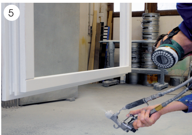
5 Beim Lackieren der Flügel- und Blendrahmen der Fenster muss der Geselle aus Gesundheitsgründen eine Atemschutzmaske tragen.
