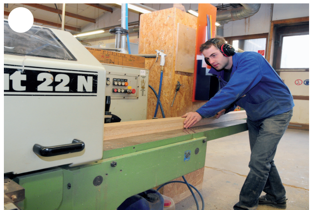
Mit dem Vierkanthobel werden die Profile aus Holz auf das richtige Format gebracht.
