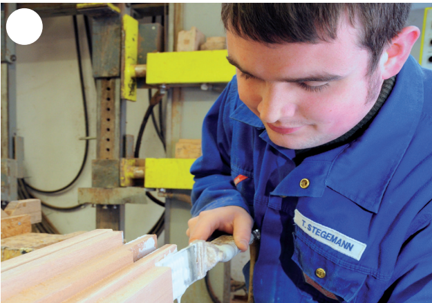
Der Geselle trägt Leim auf, der die einzelnen Teile des Fensterflügels später zusammenhält.
