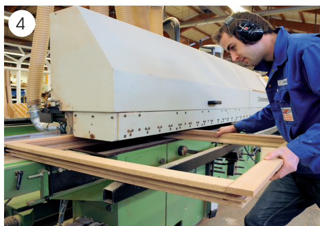
4 Am Umfälzautomat werden Unebenheiten im Profil des Fensterflügels geglättet.
