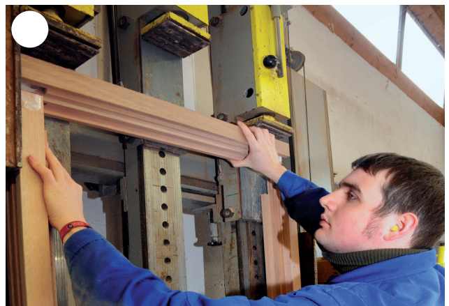
Die mit Leim bestrichenen Einzelteile des Fensterflügels werden an der Presse unter großem Druck zusammengefügt.
