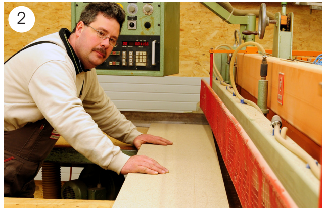
2 Aus Werkstoffplatten werden die Einzelteile der Küche zugeschnitten.
