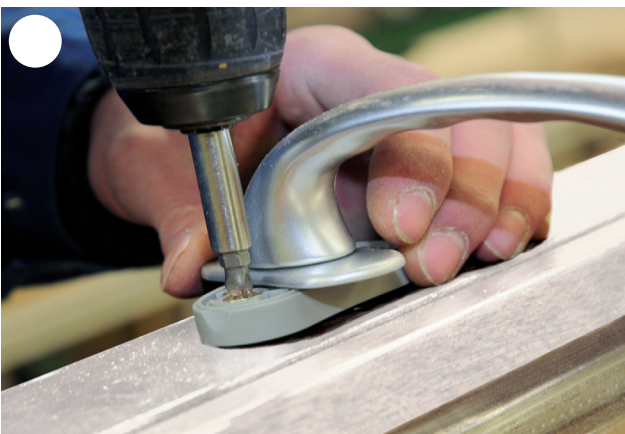
Zum Abschluss der Fensterproduktion in der Tischlerei werden die Scharniere und Griffe am Fenster montiert.
