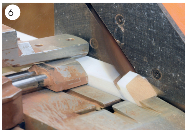
6 Die Glashalteleisten werden auf Gehrung zugeschnitten, damit sie in das Profil des Fensterflügels eingesetzt werden können.
